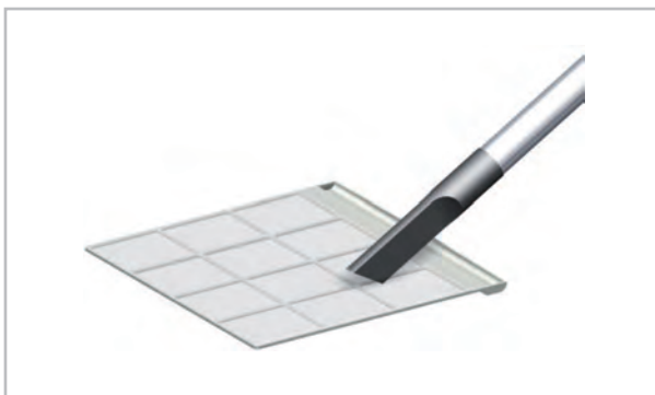
Abb. 22: Reinigung mit dem Staubsauger
